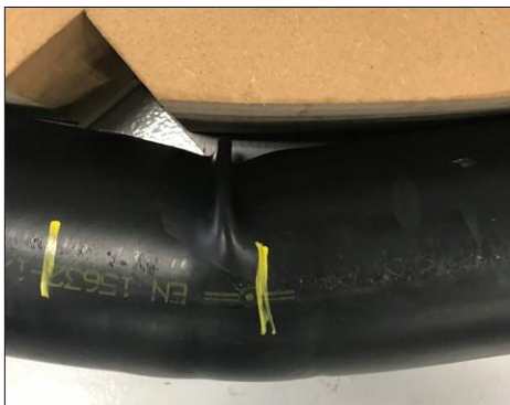
Isoplus - foldninger i rør og flydning i kappemateriale
