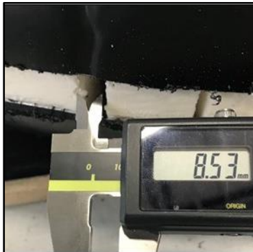
Isoplus - foldninger i rør og flydning i kappemateriale
