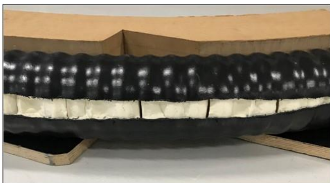
Brugg - mange revner
